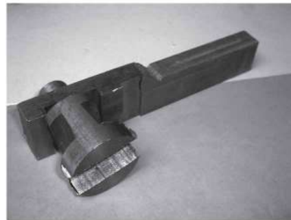
Figura 36. Montaje del portaburil con pieza principal y pieza ajustable
