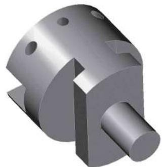
Figura 9. Diseño de pieza ajustable con ranura en forma de doble C
