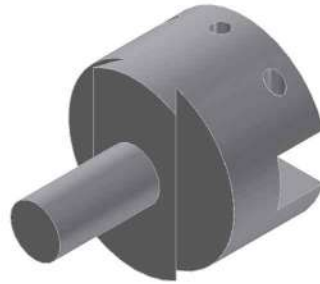
Figura 7. Diseño de pieza ajustable con ranura en cola de milano
