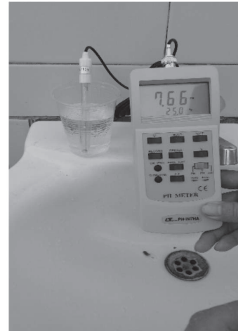
Figura 15. Ph medido con sonda de ph en el agua proveniente de la tubería residencial
