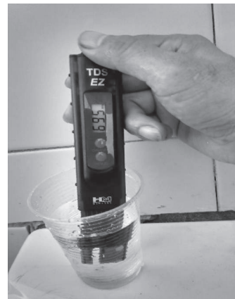
Figura 17. TDS medido dispositivo comercial en el agua proveniente de la tubería residencial
