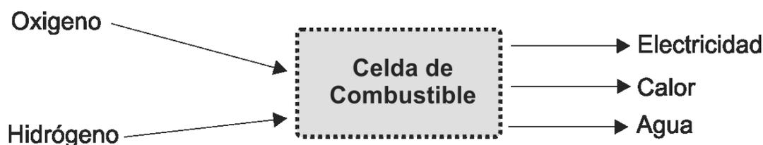
**Figura 3** Entrada y salida de una celda de combustible. Fuente: Rozo Q y Tibaquira G.
