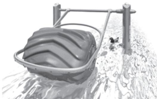
**Figura 3.** Un modelo de turbina de río balsa
