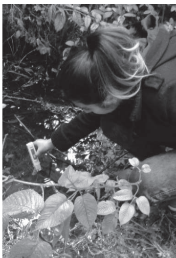
Figura 2 Medición de TDS
