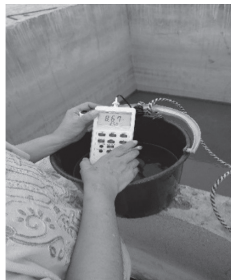
Figura 12 Medición de Ph con sonda de PH del agua almacenada
