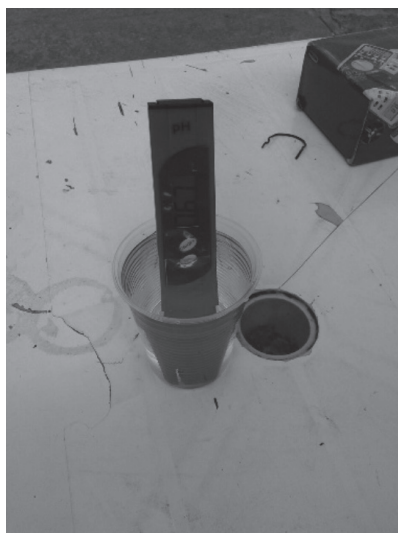
Figura 19. Ph con agua de mar, medida con dispositivo Comercial
