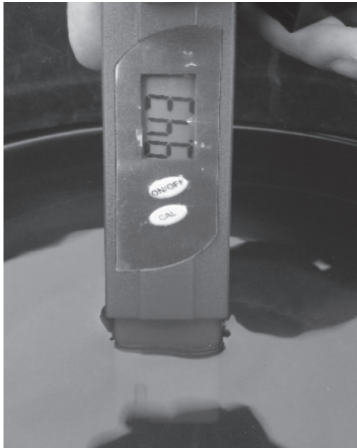
Figura 14. Valor de Ph medido en el agua de la red de acueducto del cabo de la Vela con dispositivo comercial
