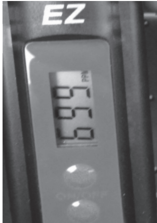
Figura 13. Valor de los TDS medido en el agua de la red de acueducto del cabo de la Vela
