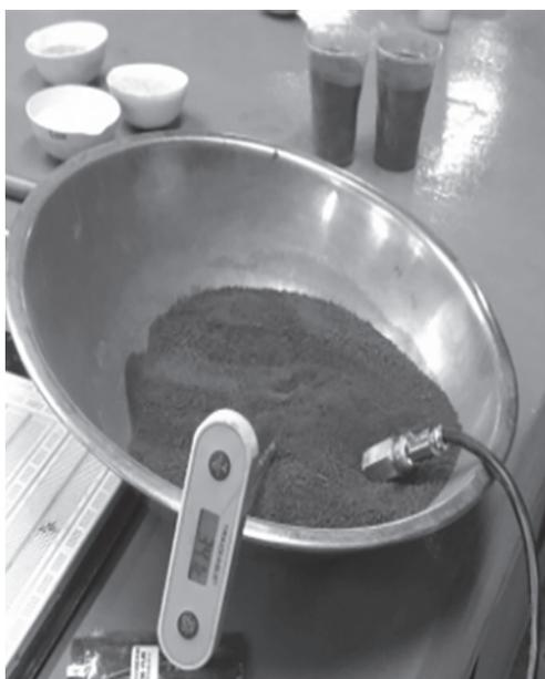
Figura 8. Medición de temperatura con sensor SHT10
